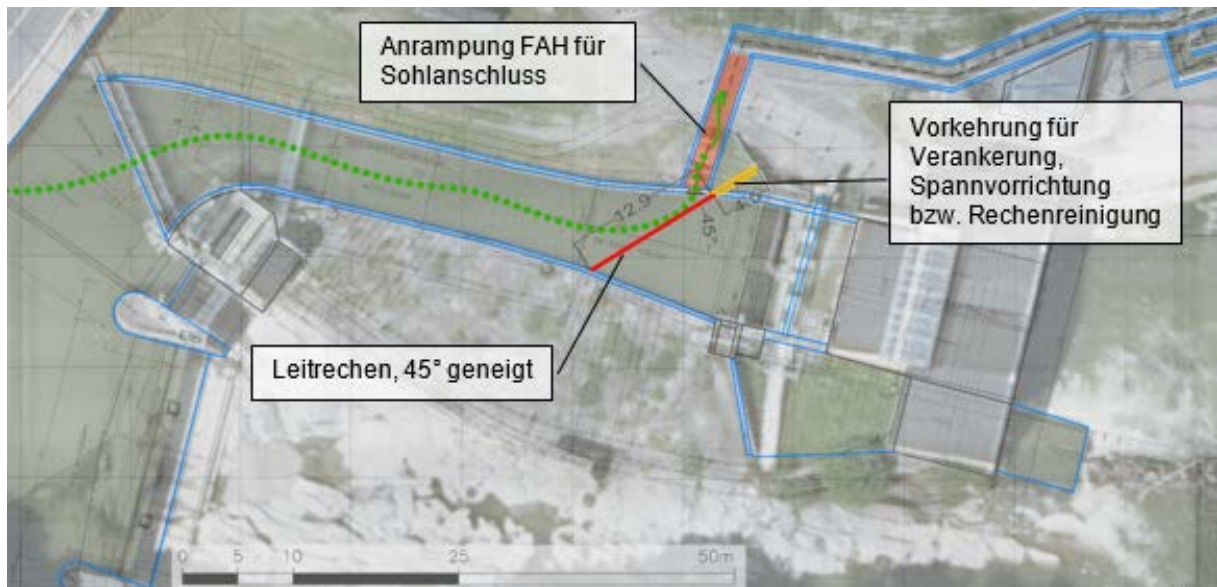
Abbildung 15: Abschirmung der Kaplan-Turbinen mittels Leitrechen (Anströmwinkel 45°) und Leitung von Fischen in Richtung Abstiegsmöglichkeit (FAH); V_{A,zul} kann nur bedingt einhalten werden (Fischlänge \geq 20 cm: Q \leq Q_{168} ), Profilsicht: siehe Anhang (Abbildung 21)
