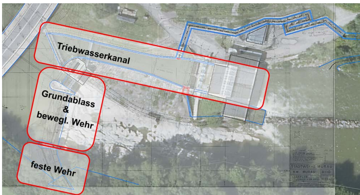
Abbildung 13: Großräumige Lage möglicher Fischschutz- bzw. Fischabstiegsvarianten
