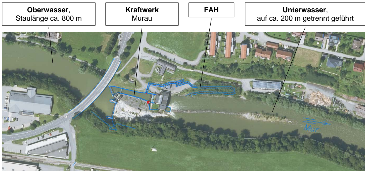
Abbildung 1: Übersicht des Kraftwerkstandorts Murau mit Fischaufstiegshilfe (FAH) sowie Ober- und Unterwassersituation
